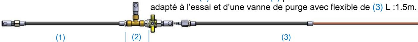
De manomètres Ø63 0/60mb et 0/10B avec gaine de protection et embout type Staübli RBE03. De deux bouchons mâle en 6/20JPC, 10/32JPC et femelle 3/4JSC munis d'embout type Staübli RBE03.
